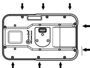
**6** Insira os parafusos nas cavidades e faça o fechamento, de forma alternada, até a junção completa das peças. Não aplique força excessiva.
