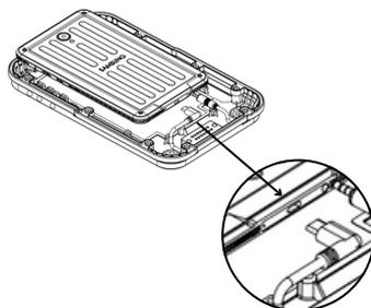
**3** Em seguida, posicione o tablet na região interna da tampa superior.
