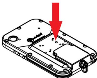
**7** Insira os parafusos nas cavidades e faça o fechamento, de forma alternada, até a junção completa das peças. Comece a aparafusar pelas extremidades. Não aplique força excessiva.
