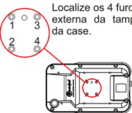
Em seguida, posicione a base sobre os furos da parte externa da tampa inferior.
