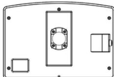
Insira as arruelas e os parafusos nos furos da parte externa da tampa inferior.
