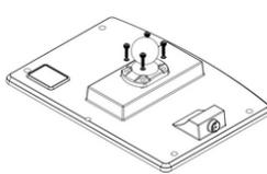
Insira as arruelas e as porcas nos parafusos expostos na parte interna da tampa inferior.
